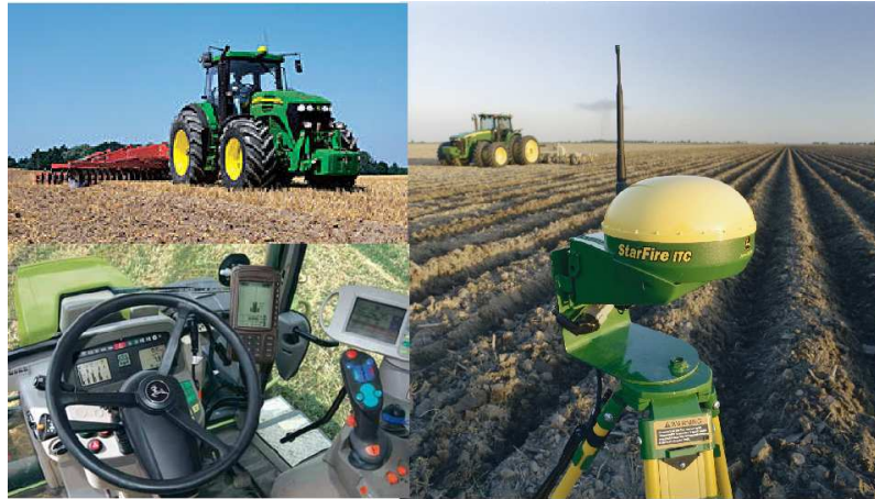
FIGURE 1.2 – Exemple d'un système de guidage automatisé : l'Autotrac de John Deere
