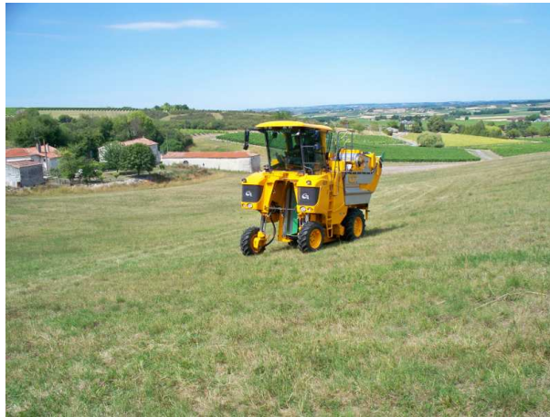
FIGURE 1.5 – Machine à vendanger Grégoire G7, machine expérimentale pour le projet Acti-SurTT, dotée de mobilités internes
