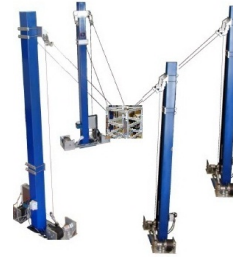
Fig. 1. The LIRMM/Tecnalia ReelAx8 robot
