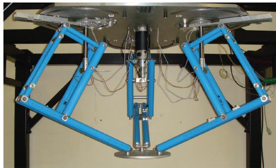
(c) Prototype de robot spatial nommé PAMINSA réalisé à l'INSA de Rennes
