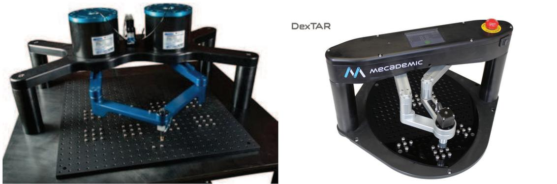
(a) Prototype de mécanisme plan à cinq barres réalisé à l'École de technologie supérieure de Montréal (b) Mécanisme plan à cinq barres vendu par la société Mecademic
