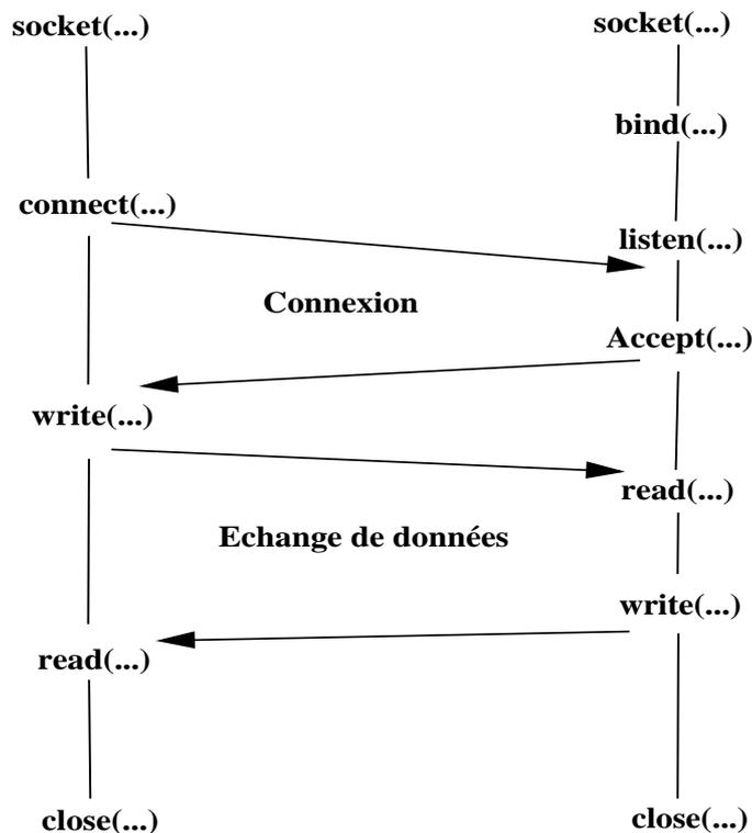
FIG. 1 – Architecture des applications C/S avec connexion
