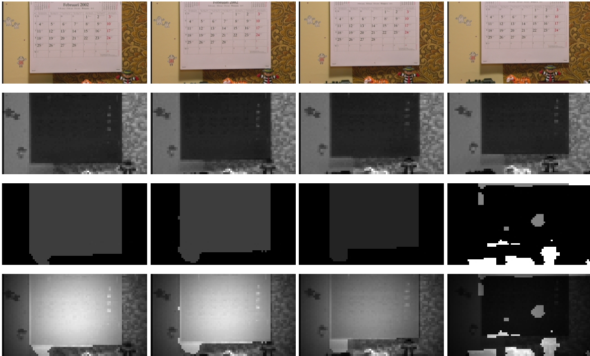
FIG. B.4 – Cartes de saillance pour la séquence New Mobile and Calendar (segments 43 à 46), avec de haut en bas : images originales, cartes de saillance spatiale, cartes de saillance temporelle et cartes de saillance spatio-temporelle.
