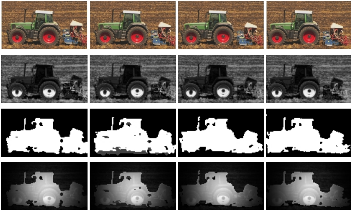
FIG. B.3 – Cartes de saillance pour la séquence Tractor (segments 13 à 16), avec de haut en bas : images originales, cartes de saillance spatiale, cartes de saillance temporelle et cartes de saillance spatio-temporelle.
