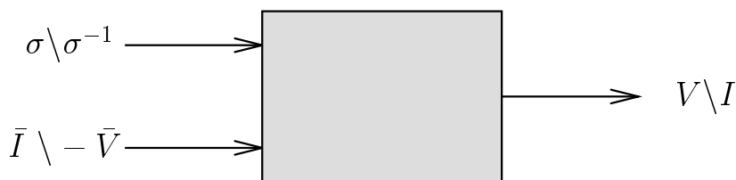
FIG. II.2 - Symétrie de la résolution du problème direct avec la formulation intégrale. La résolution du problème V, \sigma \rightarrow I s'effectue avec le même opérateur que le problème I, \sigma \rightarrow V , en permutant les entrées à un signe près et en inversant la conductivité.
