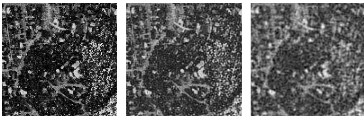
FIG. 6.2 – Objet « vue aérienne » estimé par la méthode marginale. A gauche l'objet vrai, au centre l'objet estimé pour un bruit de 1%, l'erreur entre l'objet vrai et l'objet estimé est de 22%. A droite pour un bruit de 14%, l'erreur entre l'objet vrai et l'objet estimé est de 38%.
