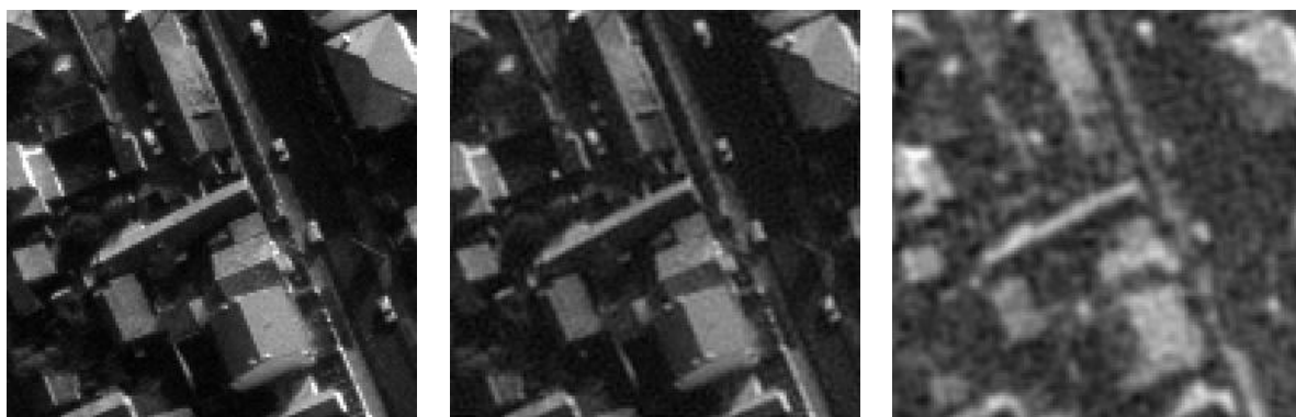
FIG. 6.4 – Objet « maison » estimé par la méthode marginale. A gauche l'objet vrai, au centre l'objet estimé pour un bruit de 1%, l'erreur entre l'objet vrai et l'objet estimé est de 7,6%. A droite pour un bruit de 14%, l'erreur entre l'objet vrai et l'objet estimé est de 17%.
