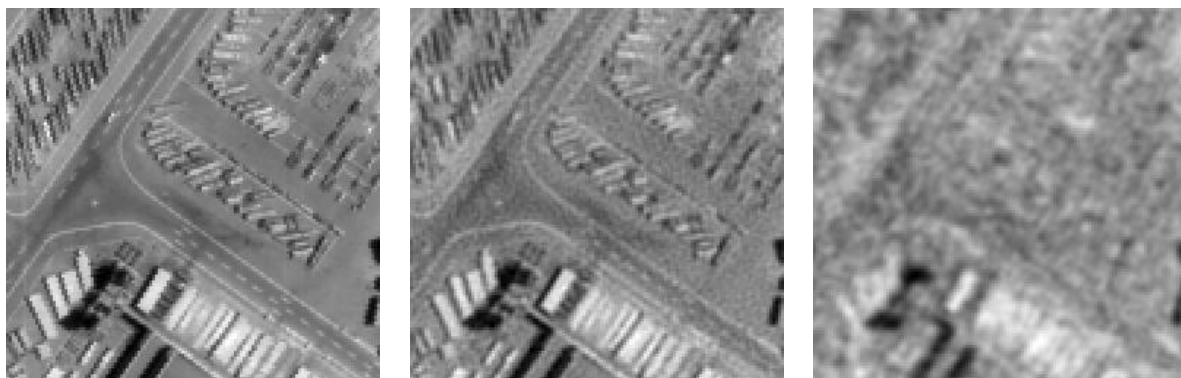
FIG. 6.3 – Objet « entrepôt » estimé par la méthode marginale. A gauche l'objet vrai, au centre l'objet estimé pour un bruit de 1%, l'erreur entre l'objet vrai et l'objet estimé est de 6,7%. A droite pour un bruit de 14%, l'erreur entre l'objet vrai et l'objet estimé est de 14%.
