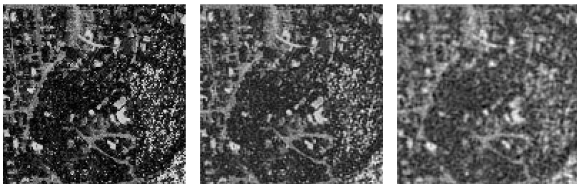
FIG. 6.6 – Objet « vue aérienne » estimé par la méthode « mixte ». A gauche l'objet vrai, au centre l'objet estimé pour un bruit de 1%, l'erreur entre l'objet vrai et l'objet estimé est de 22%. A droite pour un bruit de 14%, l'erreur entre l'objet vrai et l'objet estimé est de 41%.
