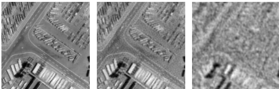
FIG. 6.7 – Objet « entrepôt » estimé par la méthode « mixte ». A gauche l'objet vrai, au centre l'objet estimé pour un bruit de 1%, l'erreur entre l'objet vrai et l'objet estimé est de 6,3%. A droite pour un bruit de 14%, l'erreur entre l'objet vrai et l'objet estimé est de 24%.
