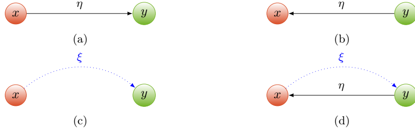
FIGURE 3.3 – Réseaux PCR de 2 nœuds. (a) Couplage linéaire d'un nœud défavorable ( x ) vers un nœud favorable ( y ). (b) Couplage linéaire d'un nœud favorable ( y ) vers un nœud défavorable ( x ). (c) Couplage quadratique d'un nœud défavorable ( x ) vers un nœud favorable ( y ). (d) Superposition d'un couplage quadratique et d'un couplage linéaire.
