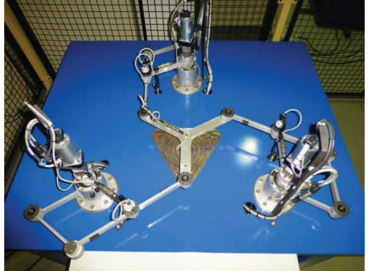
FIGURE 1.17 – Mécanisme 3RRR avec actionnements variables [Arakelian, 2008] et prototype NaVaRo de l'IRCCyN.
