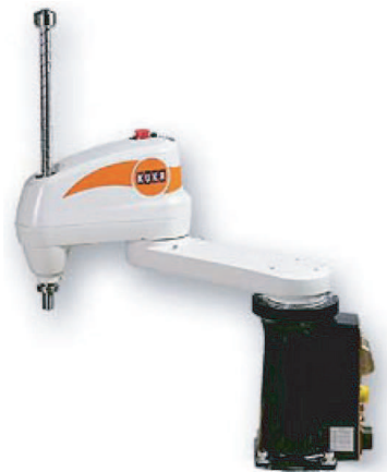
(d) Kuka – KR 5 scara R350, portée maximale 350 mm, répétabilité < \pm 0,015 mm
