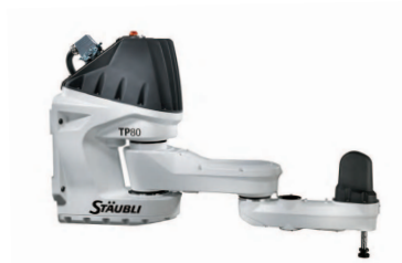
(c) Staubli - Robot TP80 Fast Picker - cycle ADEPT en 308 ms, répétabilité < \pm 0,05 mm
