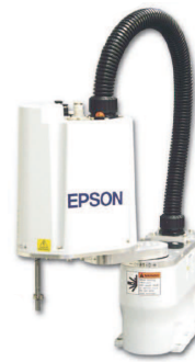
(b) EPSON - G1 Mini SCARA – cycle 100x100x100 en 290 ms, répétabilité \pm 0,010 mm
