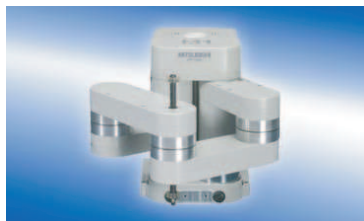
(e) Double SCARA, RP-1AH de Mitsubishi Electric – cycle 30 x 150 x 30 en 500 ms, charge 1 kg, répétabilité < \pm 0,005 mm
