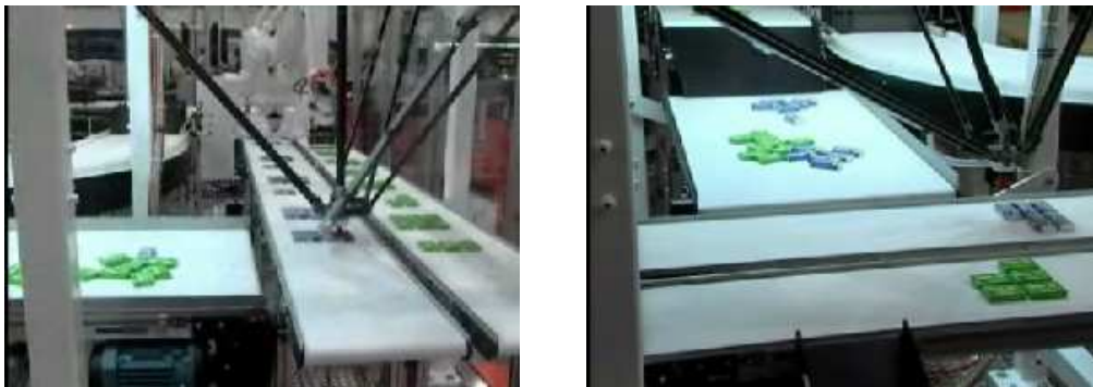
Fig. 4: Mécanisme de tracking et orientation à 3 translations et 1 rotation.
