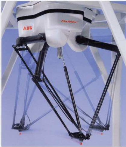
Fig. 7: Un robot Delta “Flex-Picker” vendu par ABB.
