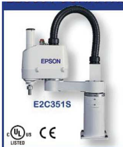
(a) Vue 3D d'un robot SCARA
