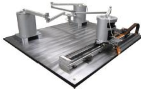
Figure 11: Prototype de mécanisme redondant 3(P) RRR de l'Institut des Système Mécatroniques de Hannover
