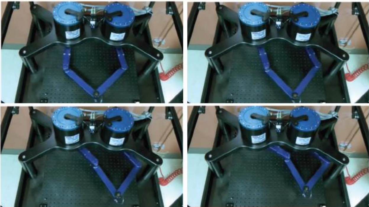
Figure 13: Extraits vidéo de changement de mode de fonctionnement d'un robot DeXtaR du laboratoire CoRo de l'ETS Montréal
