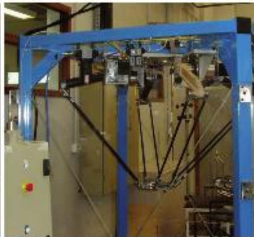
La validation des bras avec pilotage des accélérations jusqu'à 17 g
